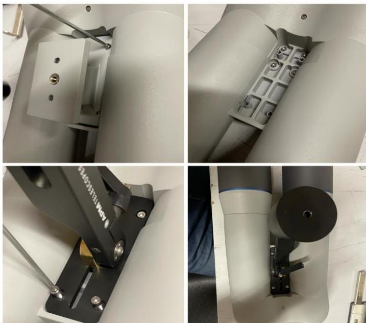
Um das Fernglas an der 1-Arm Montierung zu befestigen, muss zuerst die Montageplatte demontiert werden (Bilder oben). Hierbei ist zu beachten, dass der Vorgang je nach Fernglas leicht variiert. Im Anschluss muss die 1-Arm Montierung anstelle der montageplatte verschraubt werden (Bilder unten). Hierzu verwenden Sie den beigegefügt Sechskantschlüssel.
